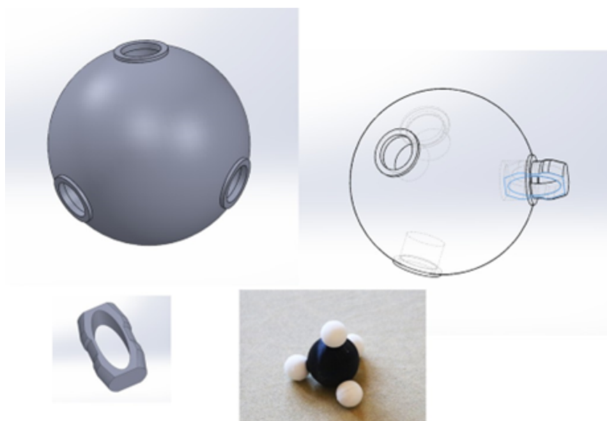
Σχήμα 4. Μοντέλο του ατόμου άνθρακα, που δείχνει τις θέσεις των τεσσάρων απλών δεσμών (φαίνεται επίσης το μοντέλο του μεθανίου \text{CH}_4 , στο οποίο ο άνθρακας συνδέεται με 4 άτομα υδρογόνου) και το μέρος που θα χρησιμοποιήσουμε για να ενώσουμε δύο άτομα σε ένα μόριο.
