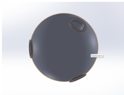
Σχήμα 11. Αντιγράφοντας τον κενό χώρο που δημιουργήθηκε στο σημείο Β, δημιουργούμε δύο ακόμη συνδέσεις σε μία από τις έδρες του τετραέδρου.
