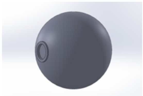
Figure 9. Découpe circulaire avec un rayon de 3 mm et une profondeur de 1 mm. Opération d'extrusion.
