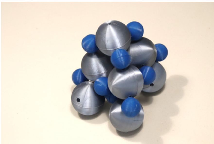
Figura 4. Modello del reticolo cristallino della silice.
